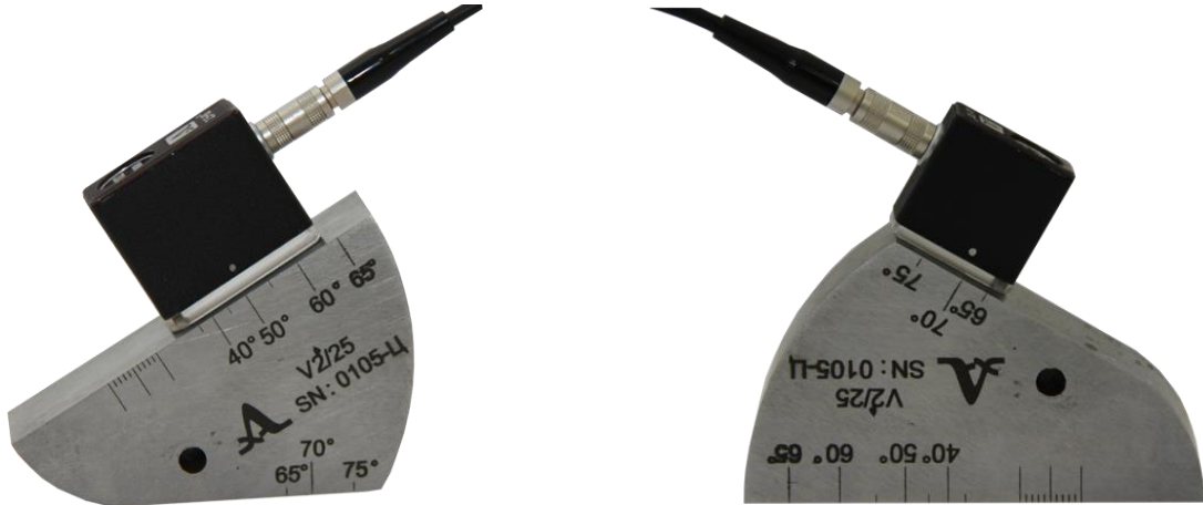
Угол калибруемого ПЭП меньше или равен 62^{\circ}
