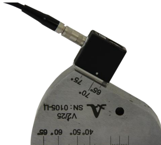
Рисунок 60 – Положение ПЭП с углом ввода \leq 62^\circ
