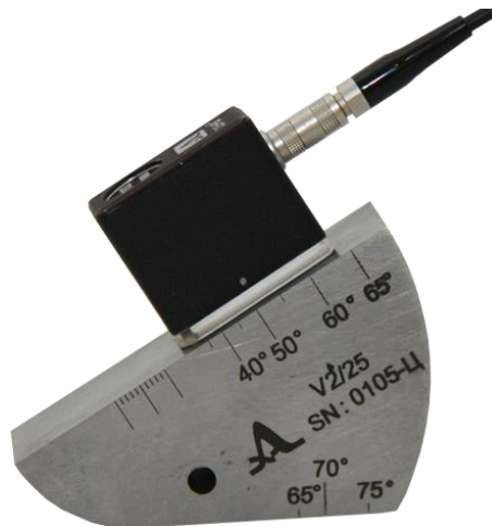
Рисунок 60 – Положение ПЭП с углом ввода \leq 62^\circ
