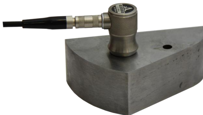
Рисунок 62 – Положение прямого ПЭП
